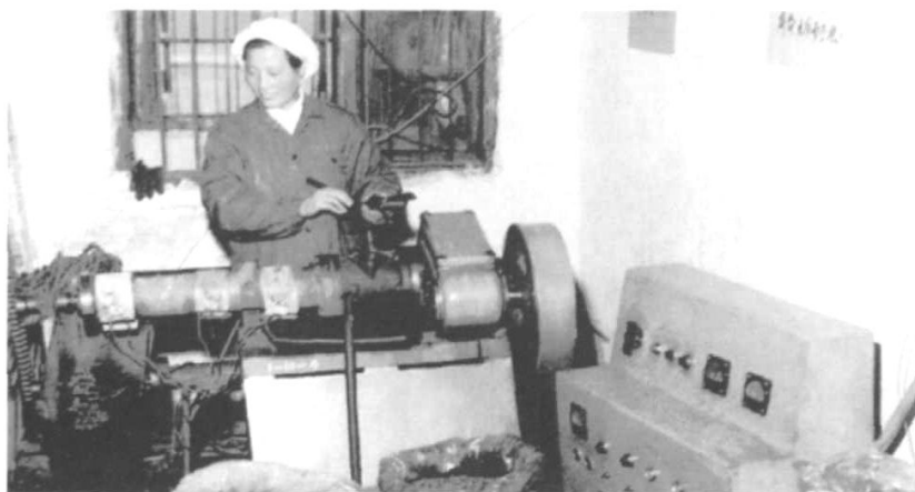
六、七十年代电工站自行设计制造的废丝（铜、铝、铅）剥皮机在运作
