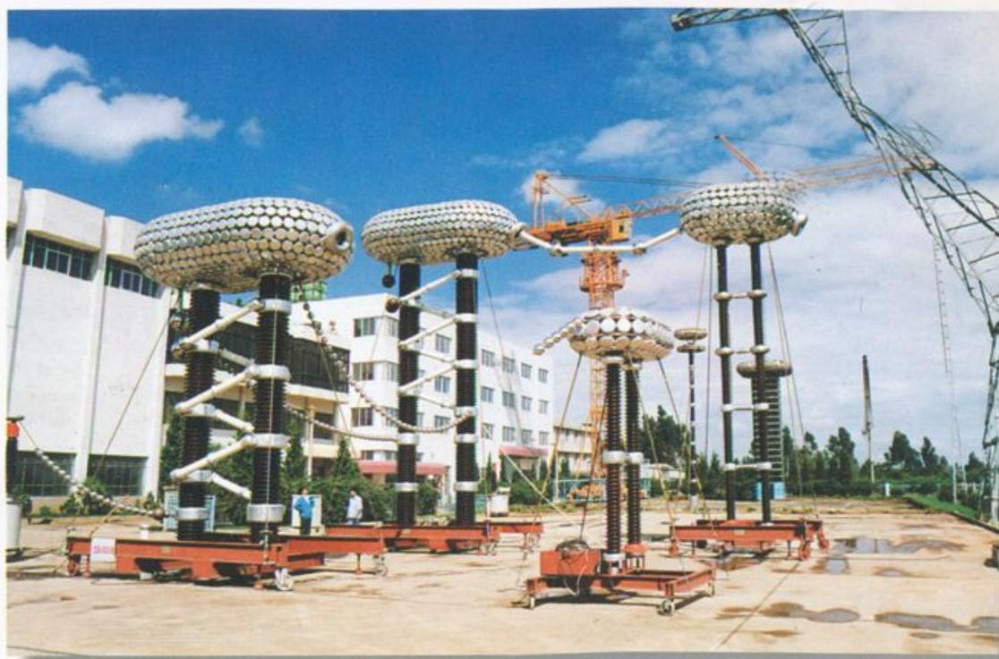
“中试基地”1200kV 直流冲击发生器
