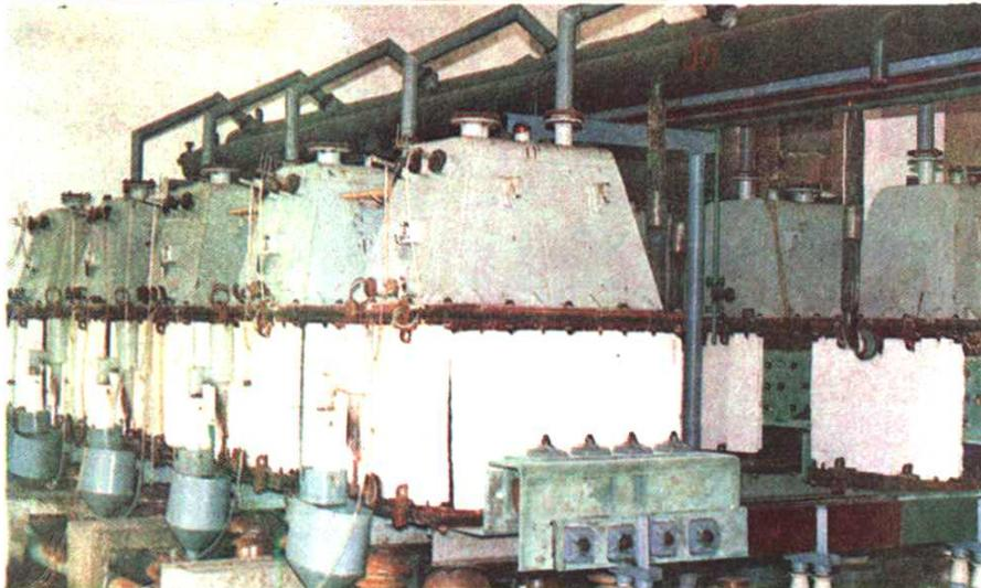
宁波电化厂 2万吨/年烧碱电解槽
