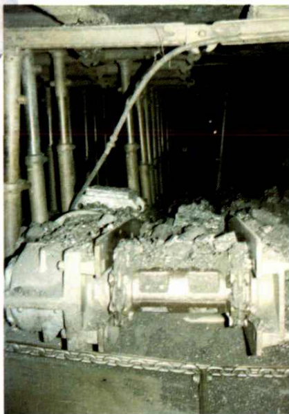
上伏煤矿长壁采煤工作面
