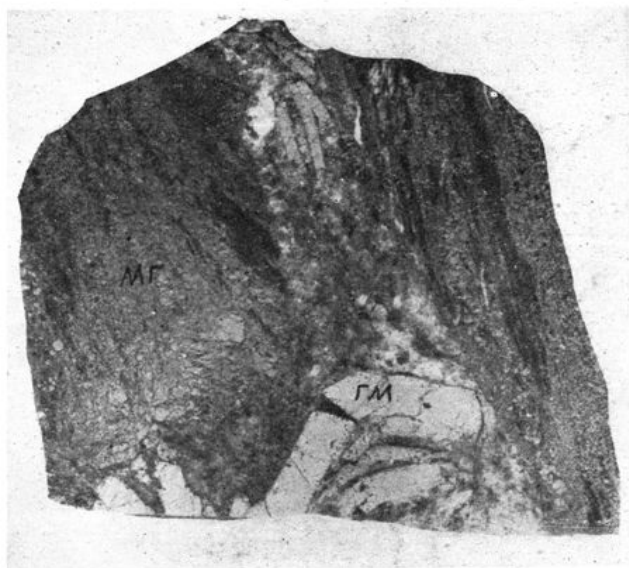
照片 11 含板状赤铁矿 (ГМ) 晶体的晚期方解石脉, 穿切了磁铁矿 (МГ), 磁铁矿矿石中含有早期的深紫色萤石 (深灰) 细脉。光片 465/58。原大
