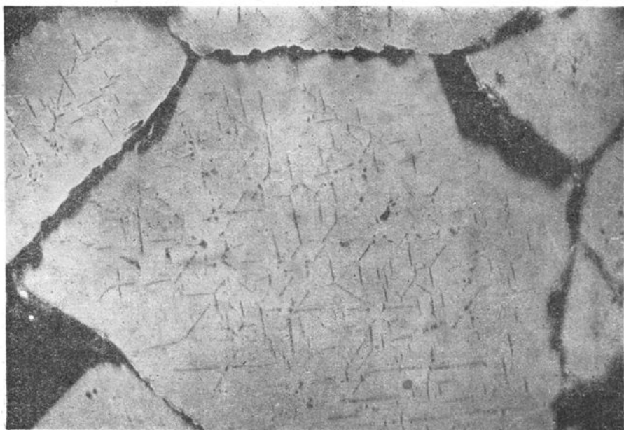
照片 4 磁鉄矿顆粒(白色)中的似板状尖晶石(暗灰色)。光片 14/58。×320
