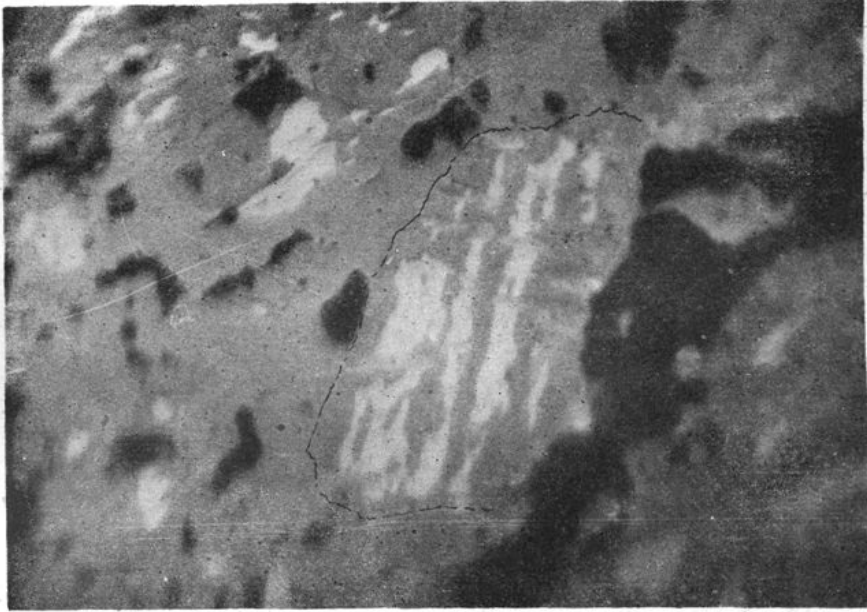
照片 14 照片中部是磁铁矿块体中的钛铁矿板状颗粒(灰色),具有赤铁矿(白色)-灰色矿物(?) -钛铁矿的固溶体分解复杂的格子构造,黑色者为碳酸盐。 光片 728/58,主矿,油浸。×1200
