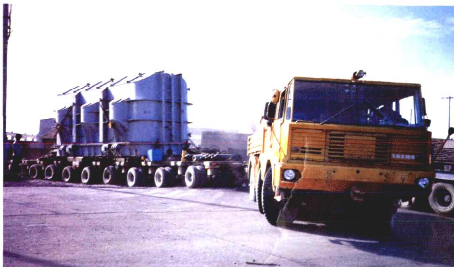
200 吨平板车运输台州电厂主变压器
