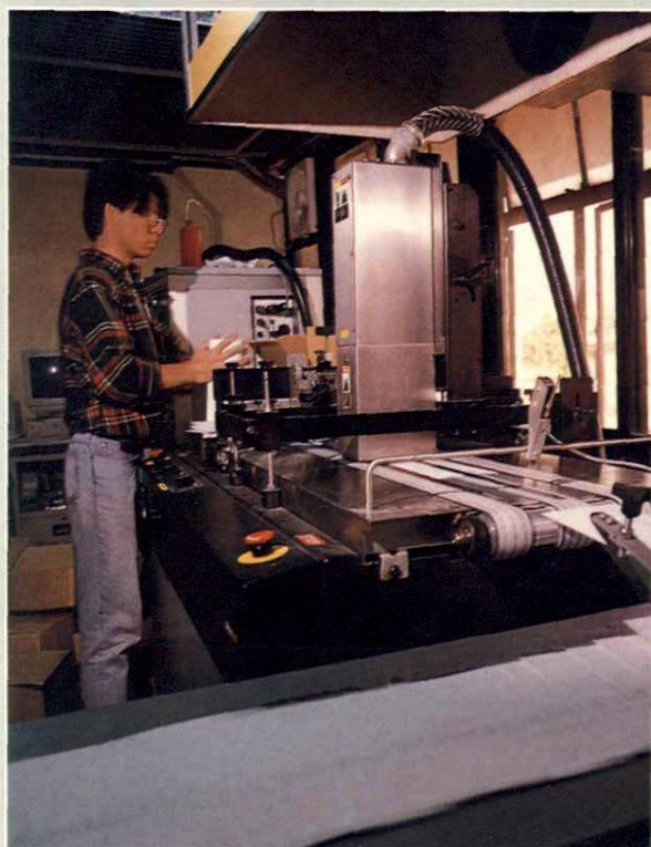
商业信函中心引进的高速自动喷墨打印系统。
