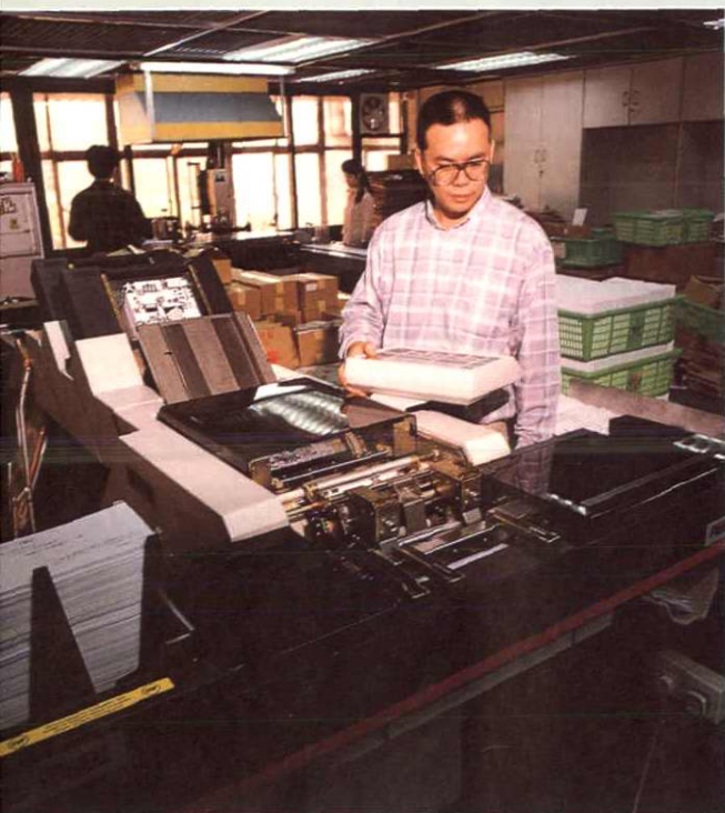
商业信函中心引进的 智能型高速封装机。
