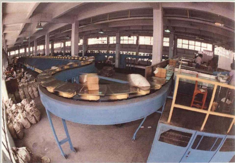
包裹车间技术改造后安装的环形分拣机。
