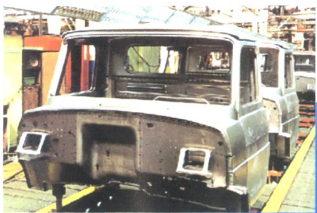
"含磷冷轧钢板研究"课题的成果之一:用含磷高强度冷轧钢板生产的中型载货车驾驶室,比原设计减轻11kg
