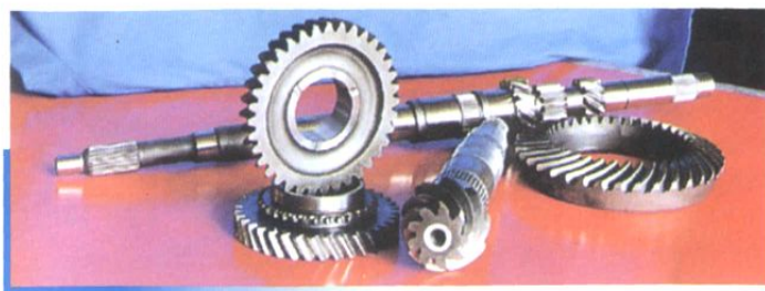
016 传动器齿轮已全部用国产钢材制造
