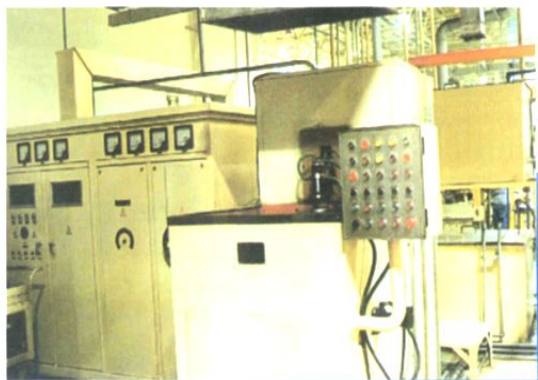
设计制造的捷达轿车前半轴自动淬火设备
