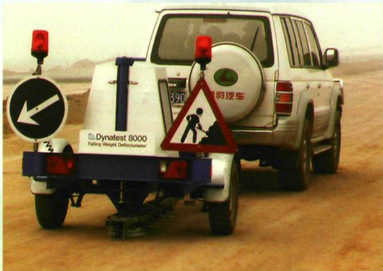
公路路基弯沉检测
