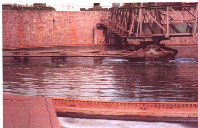
2000年投入运行的高炉煤气洗涤水处理主体设备之一——脉冲澄清池
