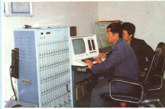
▲ 利用微机进行井下瓦斯遥测管理
