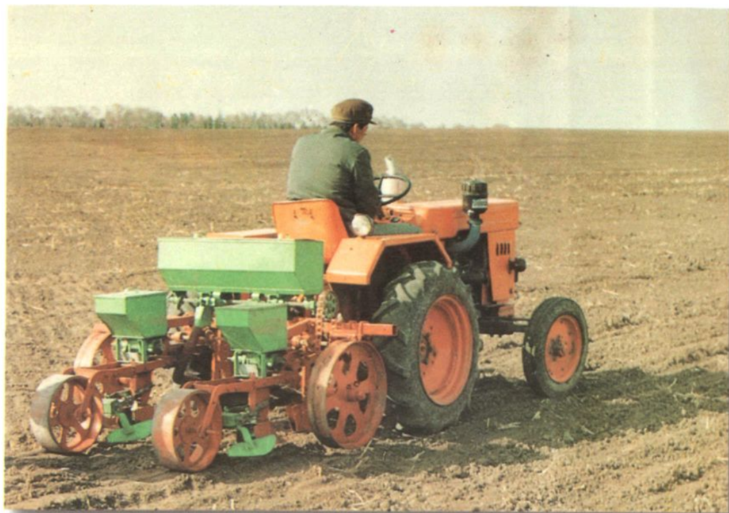
小四轮拖拉机配套播种机在田间试验
