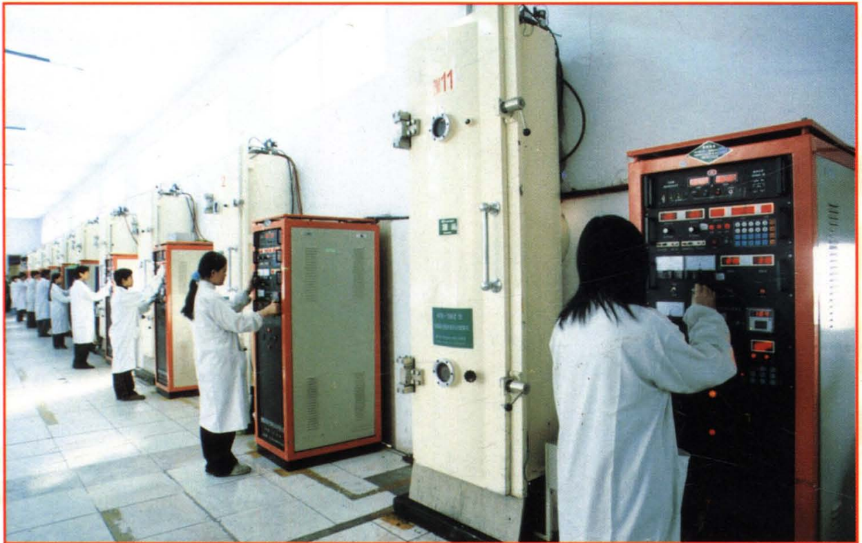
皇明集团真空管镀膜车间
