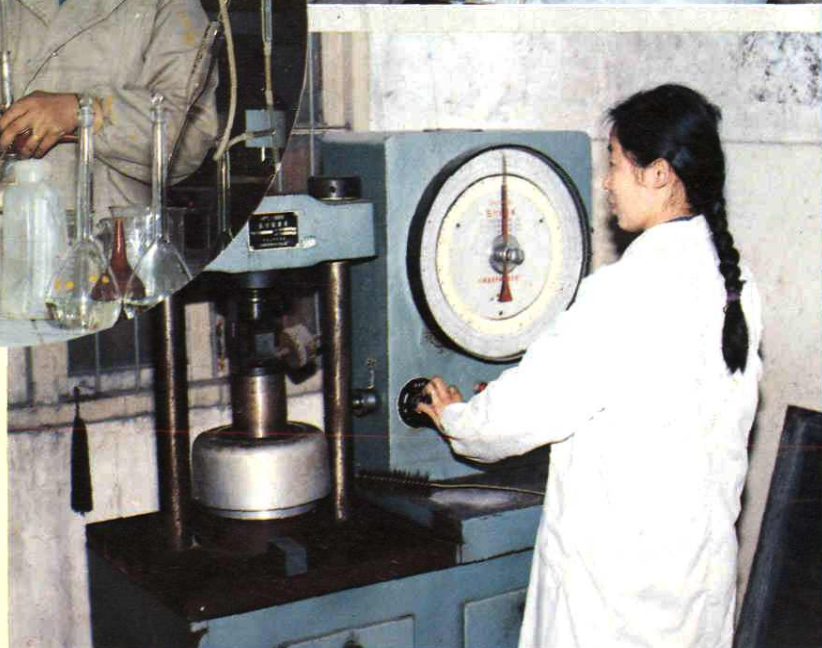
做水泥的抗壓強度試驗
