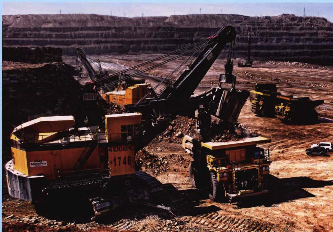
安太堡露天矿电铲与卡车联合作业
