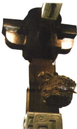
滑轮：以牵引升降重物的装置，可以改变力的方向
