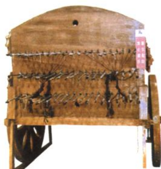
连弩之车：墨家发明的最有力的守城器械，可连续发射弓箭，并回收弓箭，极具杀伤力
