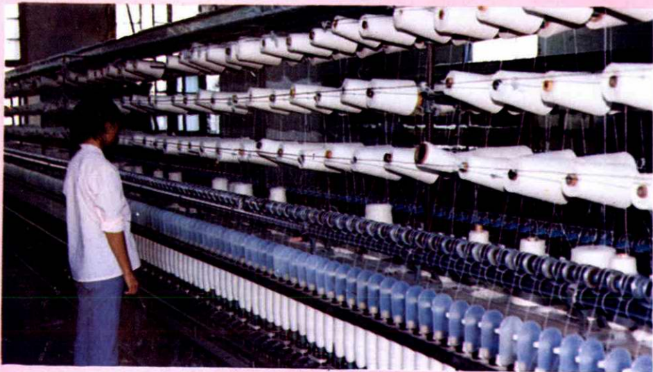
民用线厂捻线车间
