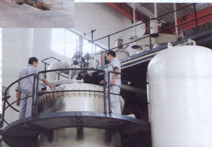
▲ 制取低杂质高性能合金粉末的真空雾化系统
