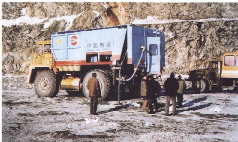
► “BCJ系列乳化炸药现场混装车”在俄罗斯卡其卡纳尔铁矿采场
