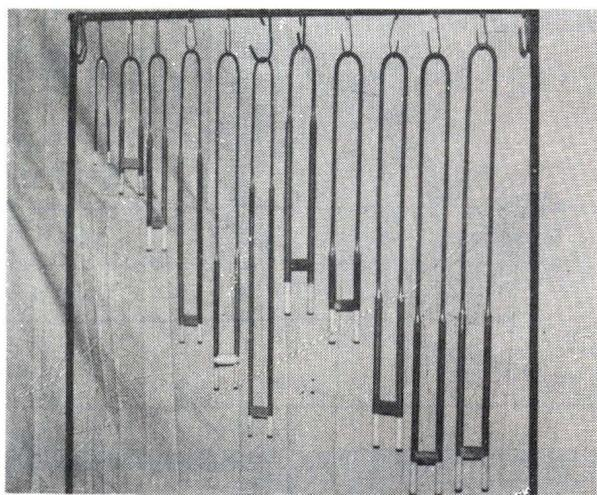
二硅化钼是本厂与天津市硅酸盐研究所联合生产的超高温1700—1800℃电炉加热元件，规格为发热端直径 $\varnothing 3$ 、 $\varnothing 6$ 、 $\varnothing 9$ 、 $\varnothing 12$ ；冷热端长度100—1000毫米和各种规格配套接线卡具。
