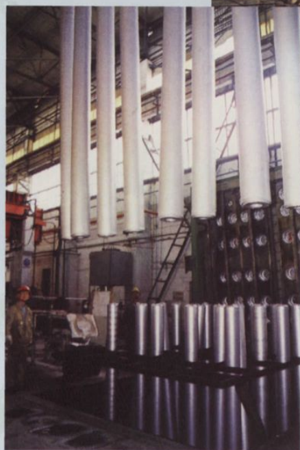
6063铝合金圆棒气幕铸造生产线
