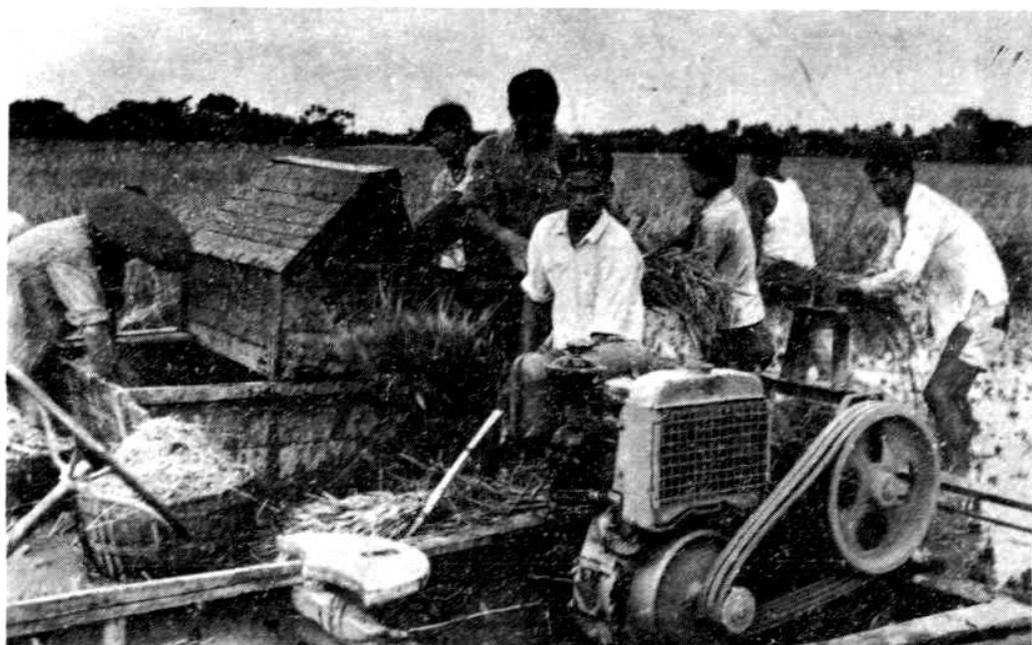
机滚船带动打稻机进行脱粒
