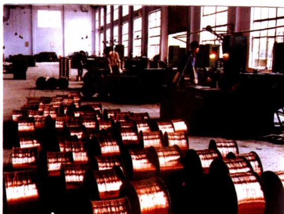
正在加工的电缆线
