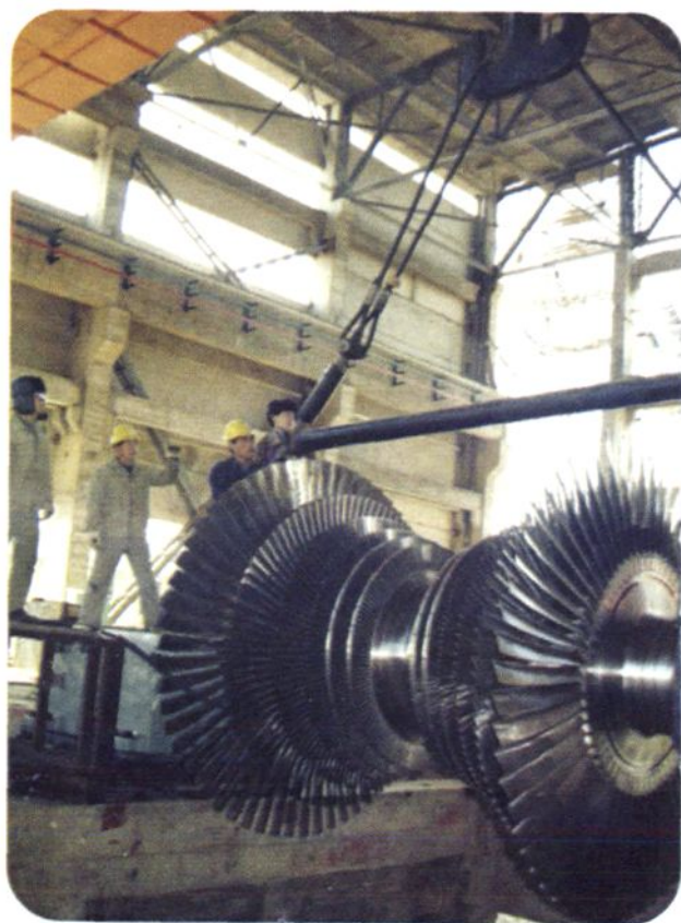
汽轮机转子吊装检修
