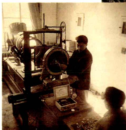
有效偏振场大型 光弹仪在进行大坝模 型的光测试验
