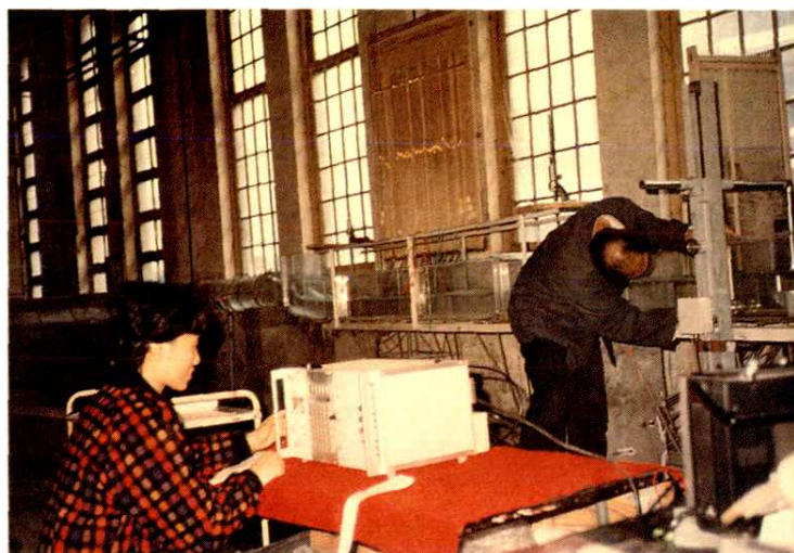
应用核技术测定水工 模型高速含沙水流掺气浓 度，精度高、速度快、不 干扰水流
