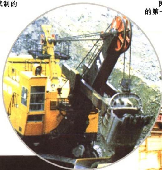
20世纪80年代太原重型机器厂自行研制的千万吨级露天采掘设备WK-10B挖掘机
