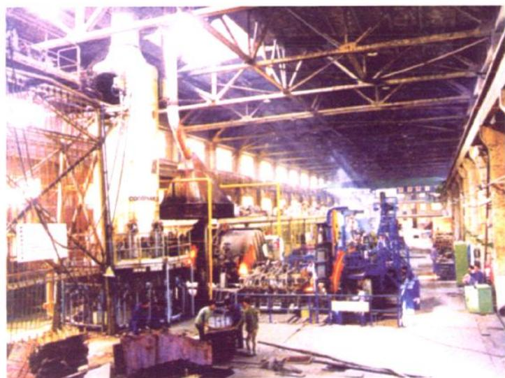
1987年投产的太原铜业公司连铸连轧光亮铜杆生产线
