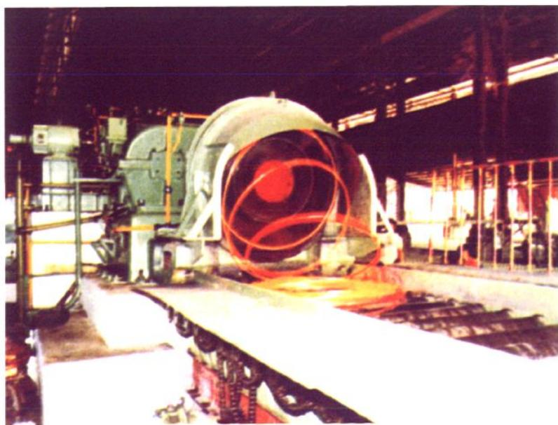
20世纪80年代初太原矿山机器厂生产的高速无扭线材精轧机
