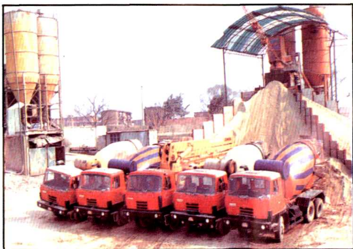
司属省建二公司为适应城市高层建筑施工的需要，建成了年生产5-6万立方米商品砼搅拌站，配有6立方米搅拌运输车四台和西德产35米砼泵车一台
