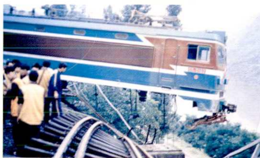
▲ 1996年6月23日，因线路堑坡滑塌，导致机车垫出轨道
