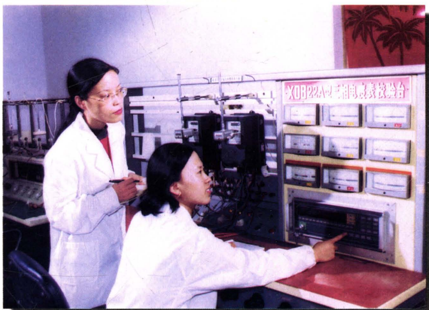
局安装了标准的计量表校验仪器，坚持周期性校验。图为 校验人员在校三相表。
