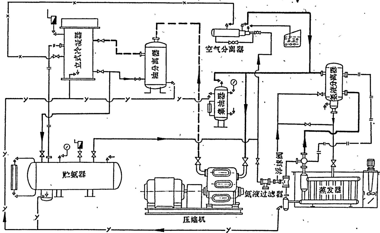
——排气管 ——吸气管 ——液体管 ——平衡管——y-y——放油管——x-x——放空气管
