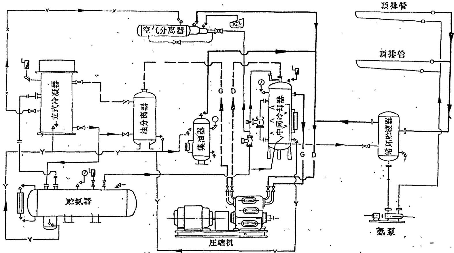
C ——— 排气管    G ——— 吸气管    ——— 液体管    —Y— 放油管    —X—X— 放空气管    —||— 平衡管
