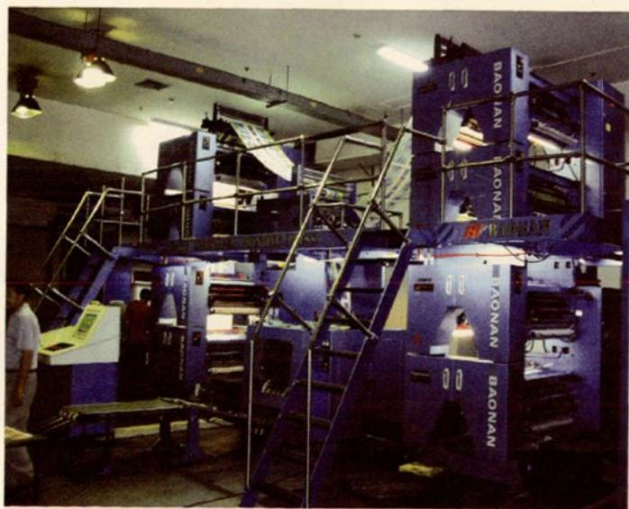
2004 年 7 月“YPT787 型宝南无轴轮转印报机在我厂正式投入使用。
