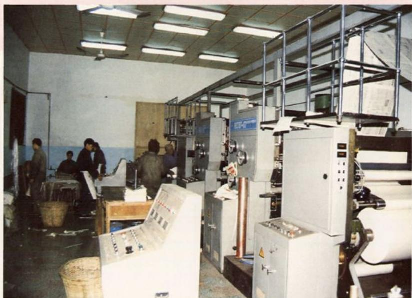
1991,工厂添置的PJ2787-02轮转胶印机在印刷报纸。
