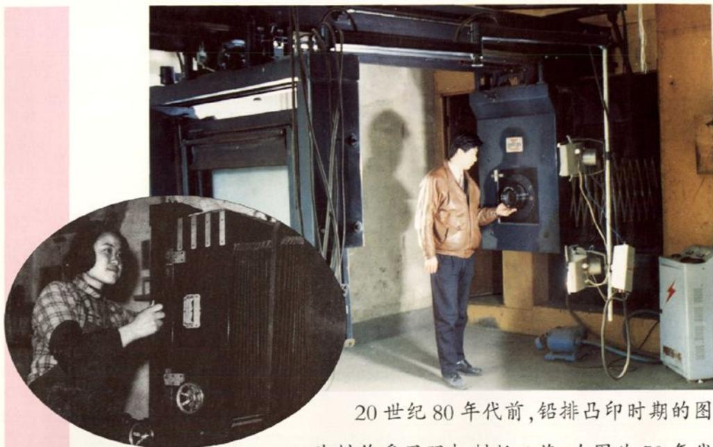
20 世纪 80 年代前, 铅排凸印时期的图片制作采用照相制版工艺, 左图为 50 年代湿片照相机, 右图为 80 年代干片照相机。
