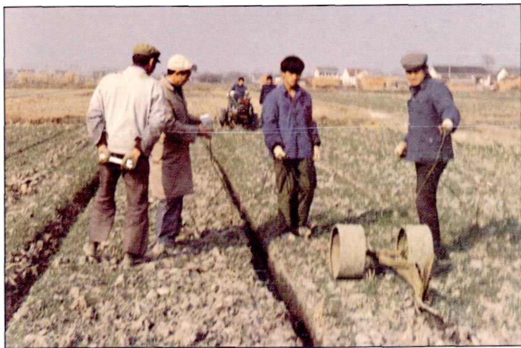
鼠道打洞机在测定拉力
