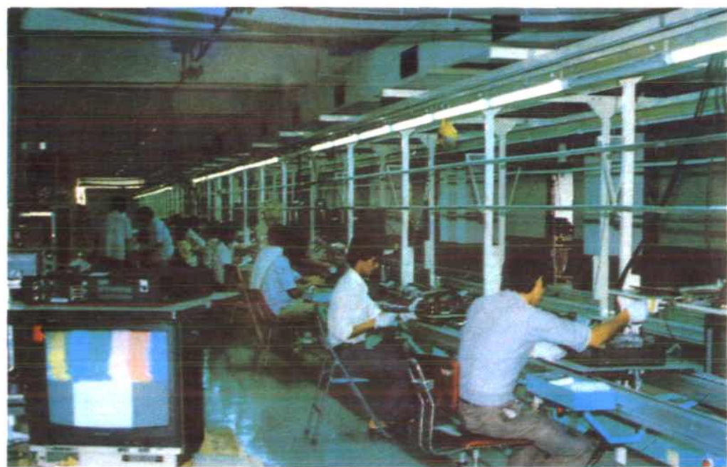
图24 录像机装配线
