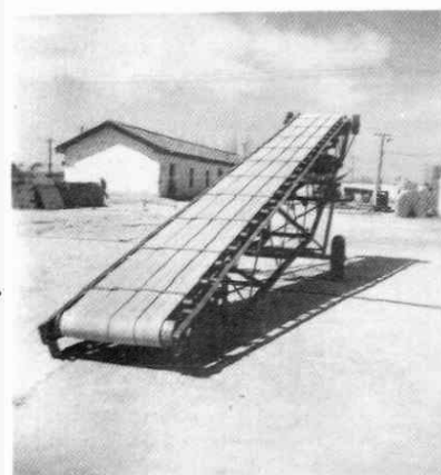
工人自制的平板输送机
