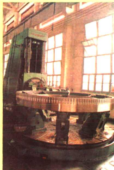
▲四川省建材机械厂采用 Y31500, 5M 滚齿机加工水泥生产设备
