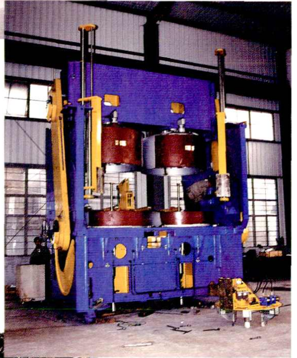
上海固特机械有限公司 生产的LL-B1525/4220 × 2子 午胎硫化机。
