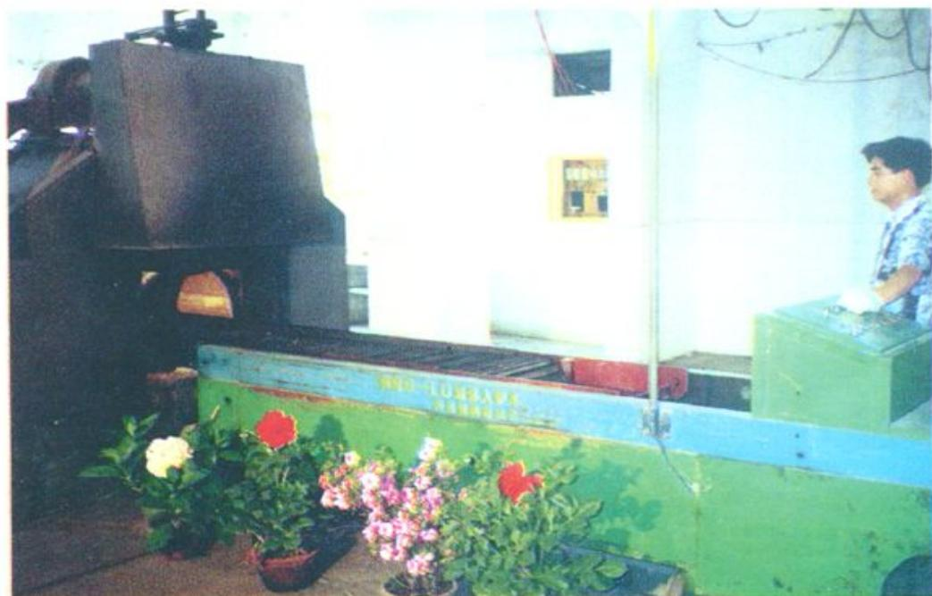
火化炉及自动进炉车
