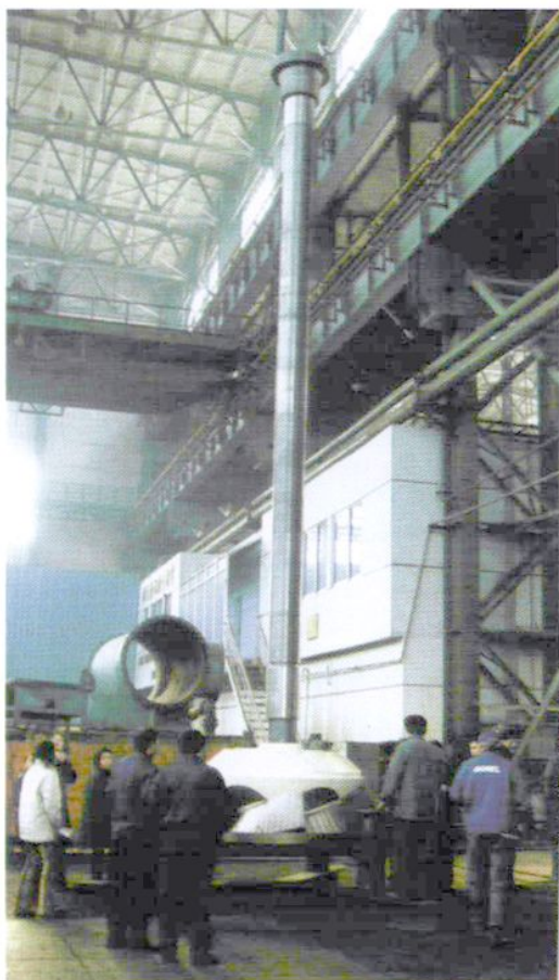
2600HTEXJ 型叶片可调立式斜流泵轴与叶轮在装配中
