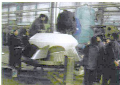
叶片可调式叶轮在装配中
