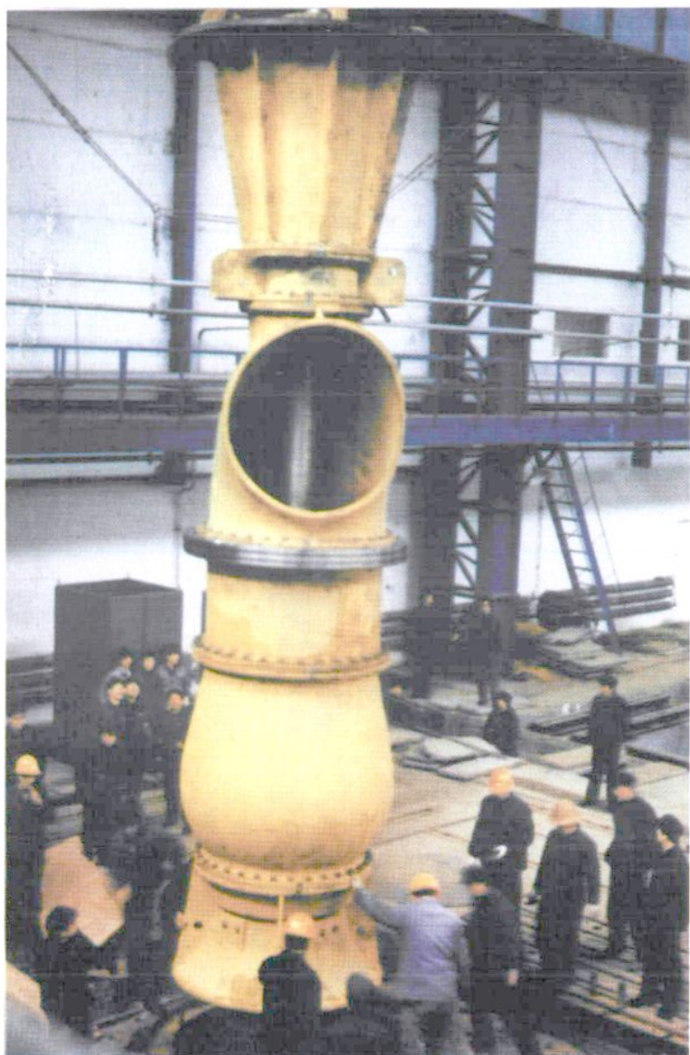
大型立式斜流泵在装配中
