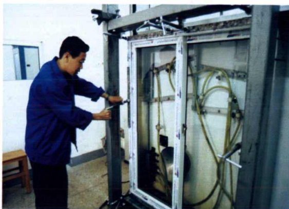
建材检验室的技术人员正在对塑钢门窗进行检测
