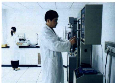
轻纺检测中心的技术人员正在操作多功能强力机检测织物强度
