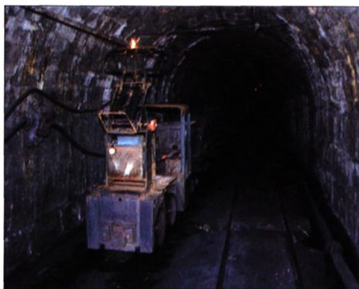
井下架綫電機車運輸
