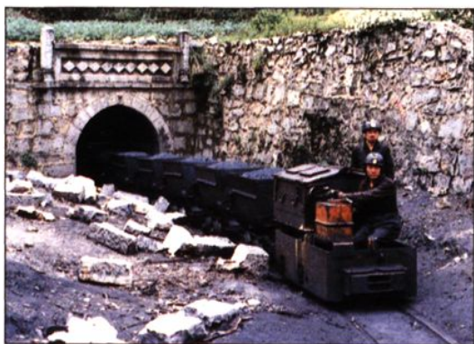
地面蓄電機車運輸
