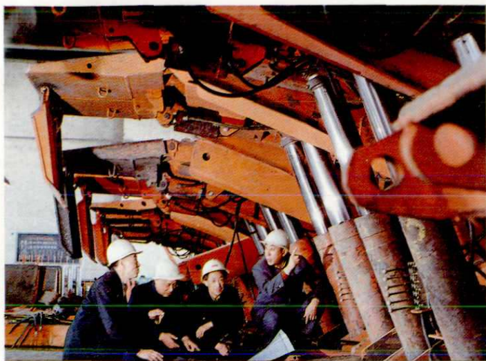
综合采煤支架修配
