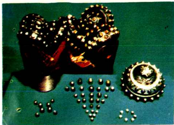
石油钻探中硬至软地层三牙轮钻 齿。
