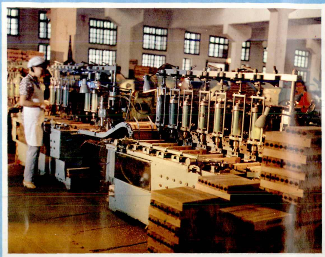
横峰纺织器材厂自行设计、安装的单机多工位电子程控液压技术加工木梭自动钻孔生产线
