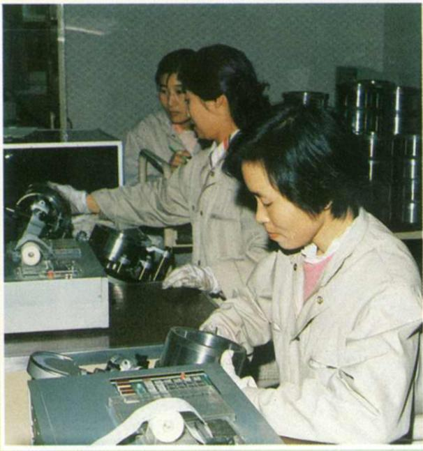
用小位移自动测量仪检测轴承
