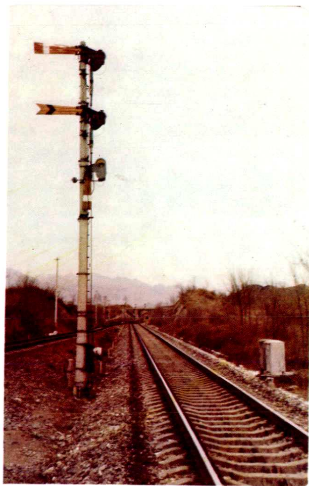
铁路信号厂产品之一 电动臂板信号机
