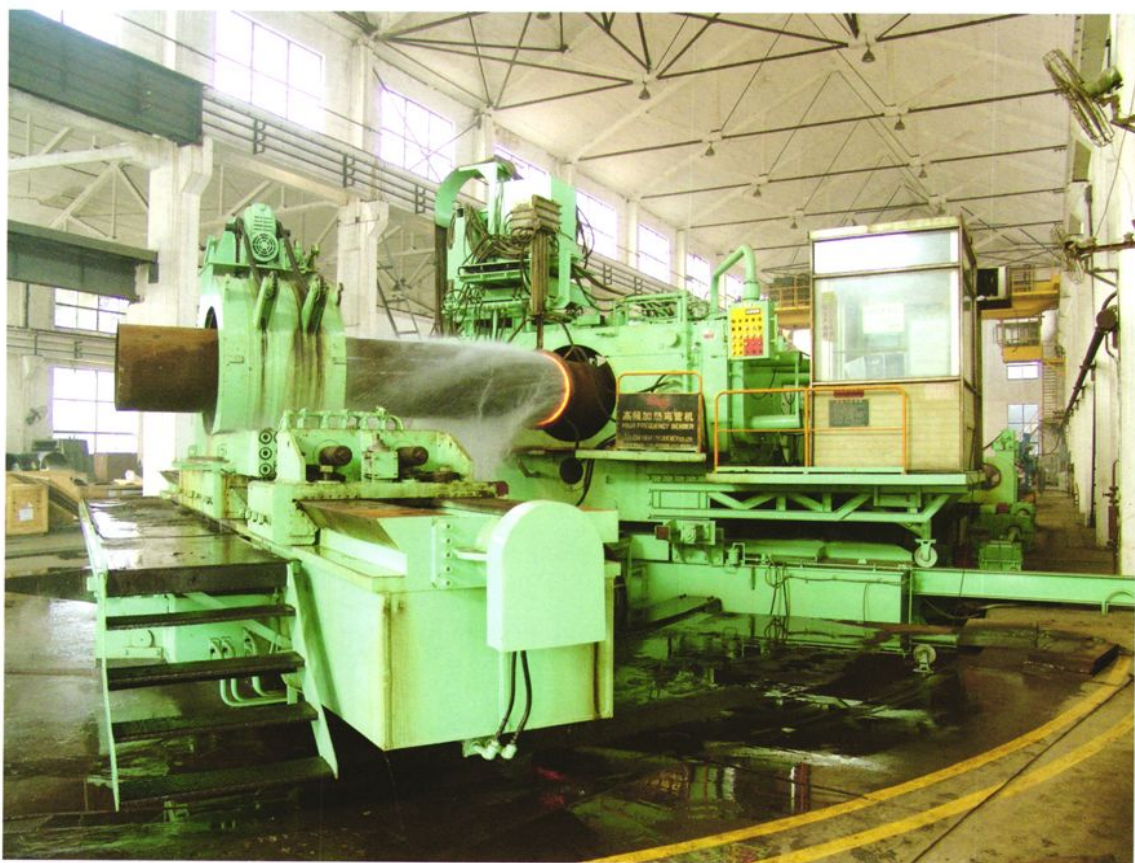
⑯江苏电力装备有限公司大型管道预制设备1000千瓦中频弯管机
