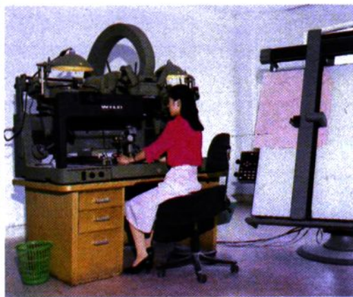
在 B8S 精密测图仪上立体测图
