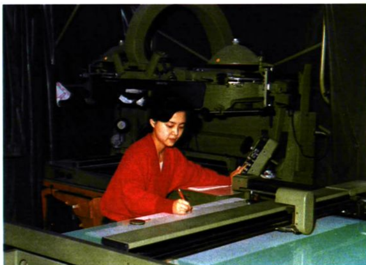
在 B8S 精密立体测图仪上进行联机数字化测图
