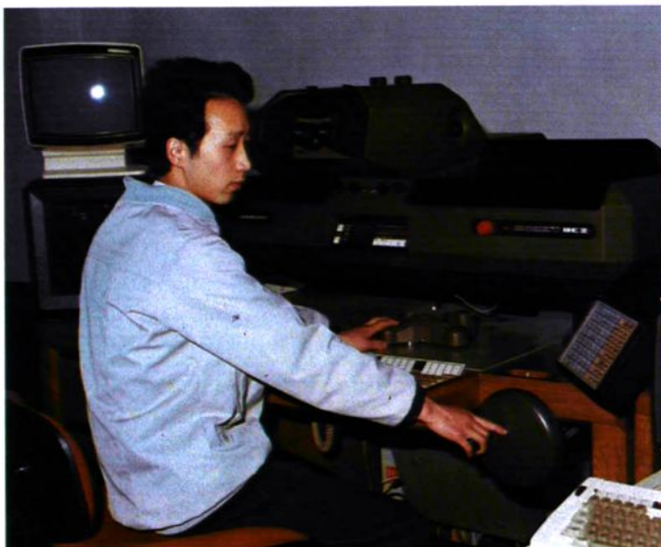
在 BC 2 解析测图仪上进行数字化测图
