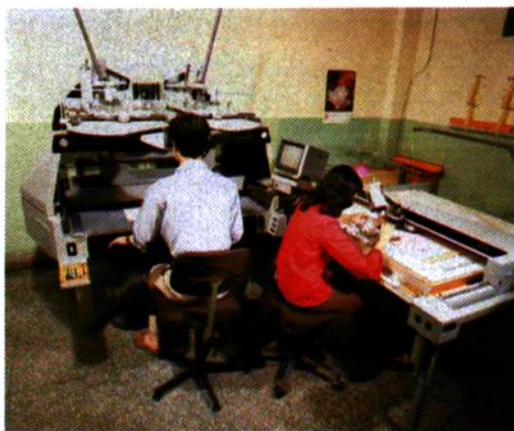
在 D_2 精密立体测图仪上立体测图
