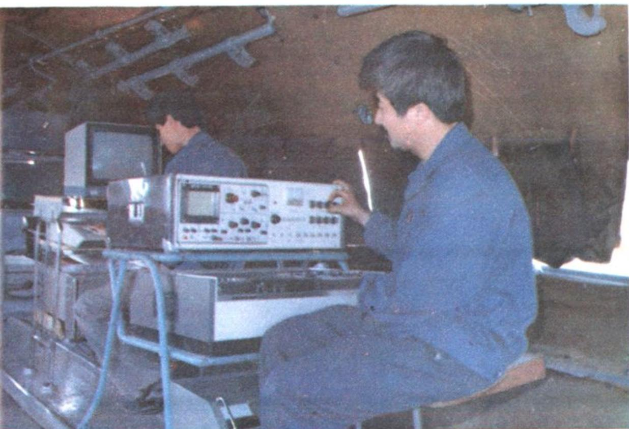
地矿部水文方法研究队研制的JHY—2型机载红外扫描系统获地质部科技成果二等奖，图为操作人员在伊尔—14飞机上进行扫描工作。
