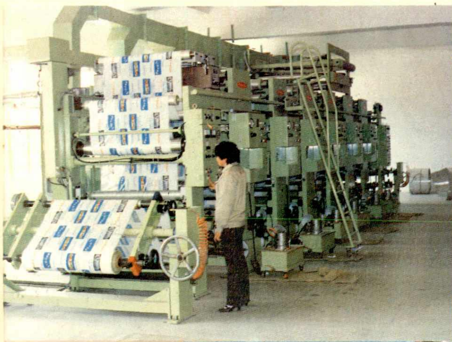
常熟铝箔厂从日本引进的 GS-100/6六色凹版轮转 印刷机
