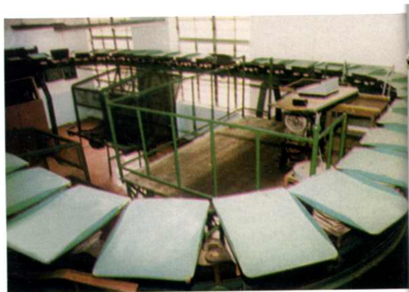
1965年邮电部第三研究所和市中区邮局研制的第一台托盘式包裹分拣机
