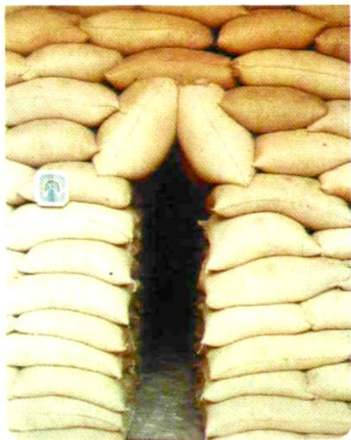
▲ 环流式堆垛自然通风储粮
